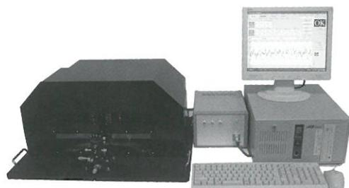
光 MEMS スキャナの基本性能を検査する装置
